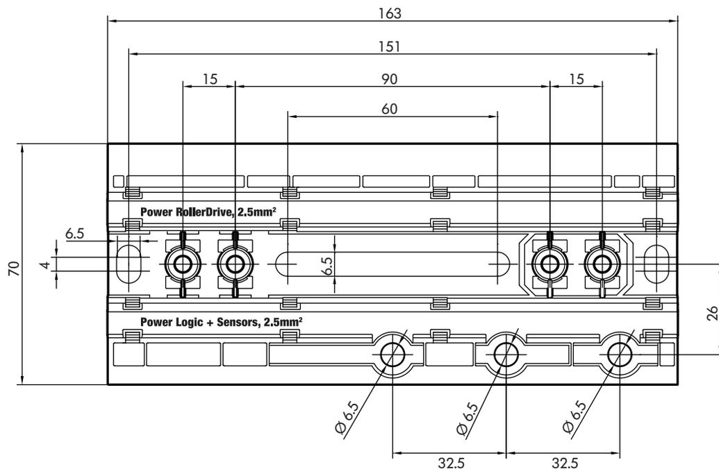
Pour que l'utilisation de la clé magnétique soit possible, l'écartement minimum entre le bord supérieur de la MultiControl et les composants voisins doit être de 10 mm.
